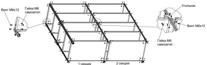
**4.4.** Установить ограничители к стойкам при помощи винтов M6x12 и гаек M6. Боковые ограничители имеют 2 места крепления, ограничители по ширине - 3 места крепления. Установить разделители книг.
